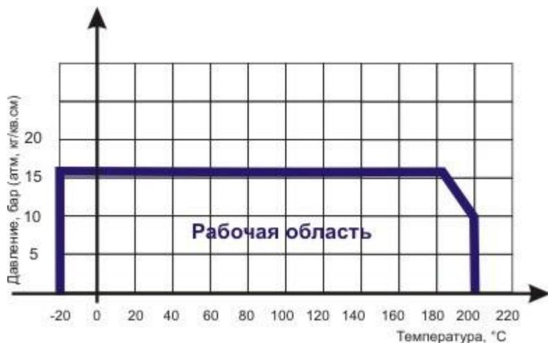
Диаграмма определяет рабочую область для фильтра сетчатого резьбового чугунного в координатах Давление (в барах приборного) / Температура (° C).
